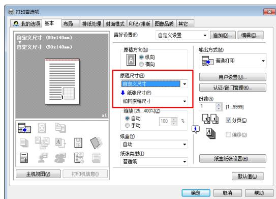
7 输入要打印的纸张的〔宽度〕和〔长度〕值，然后单击〔确定〕。
