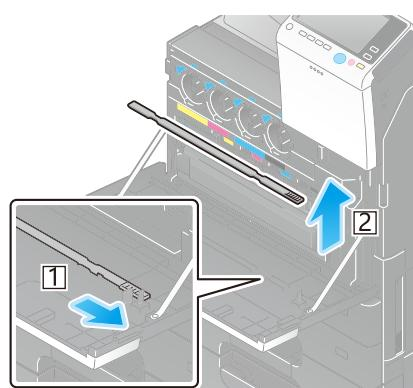
4 慢慢将**打印头清洁器**完全插入到**打印头玻璃**部位的后端，然后慢慢将其拉出。
