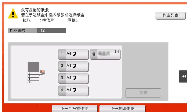
10 将明信片或信封装入手送托盘，并将进行打印的一面朝下放置。
