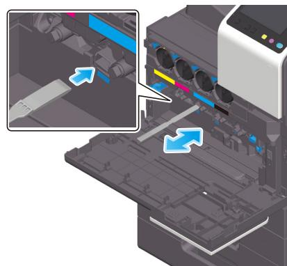
5 将**打印头清洁器**安装到机器的前门上。
