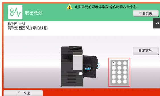
清除卡纸后，会显示指示如何正确装入纸张或原稿的画面。
