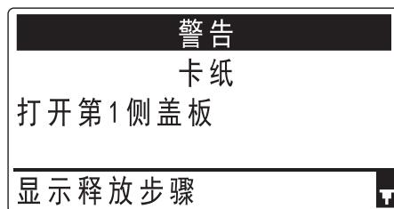
指示卡纸位置的信息将显示在**显示**上。
