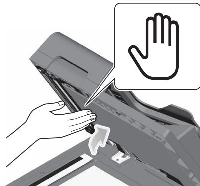
% 按下**打开和关闭导板**中央的手形标志，并检查**打开和关闭导板**是否已安全锁定。
