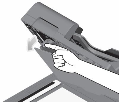
% 释放打开和关闭导板的锁定杆，然后打开打开和关闭导板。
