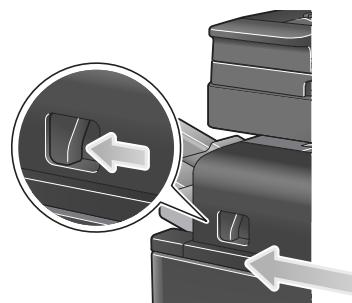
2 沿箭头方向拉动打孔组件释放杆 [FS2]，然后打开打孔组件。
